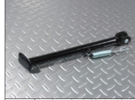
商品名 モンキースタンド10インチタイプ 税込価格 1,300円 商品説明 スタンド部分の長さは 255mm (地上からボルト中心までの距離) 商品ID NO370
