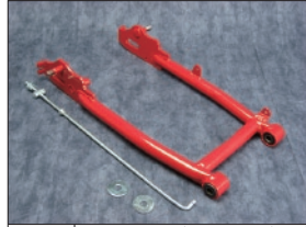
商品名 モンキー+10cmロングZ50Jリアスイングアーム赤 税込価格 5,600円 商品説明 モンキー独特のフォルムを崩さずに安定感を増すリアスイングアーム 商品ID NO1039
