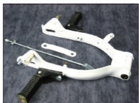
商品名 ダックス&シャリスイングアーム・タンテムステップ付 税込価格 5,800円 商品説明 タンテムステップは折りたたみ式、ブレーキ小物付属、スイングアームはノーマルサイズ 商品ID NO1150
